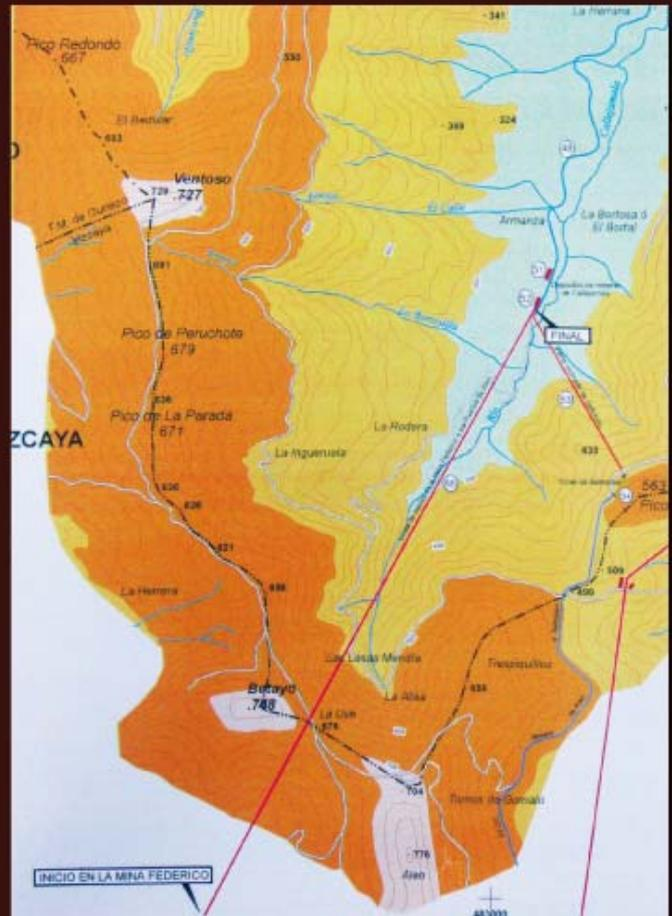
En el plano podemos observar la línea de baldes recta que desde la Mina Federico transportaba el mineral hasta el puerto II de Callejamala para su posterior traslado por el tren de la vía de Alén hasta el cargadero del puerto de Castro.
